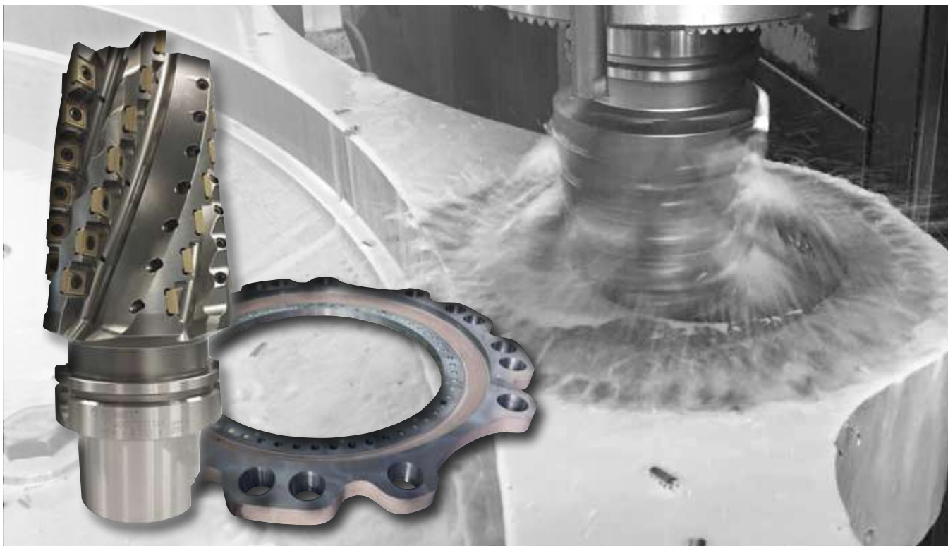
Стопорная шайба ротора: отверстие под стопорный болт \varnothing 165 мм/5°
