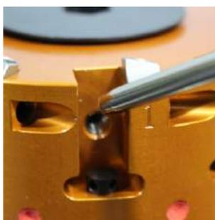
3. Продуйте корпус инструмента и отрегулируйте осевое положение винта.
