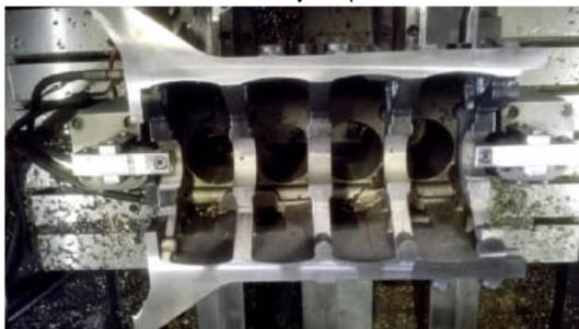
**Правильное использование пластин Wiper для обеспечения хорошей плоскостности.**
