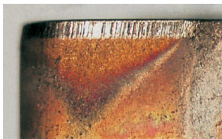
Износ по задней поверхности — один из наиболее распространённых видов износа, он возникает на задней поверхности пластины (инструмента). Это предпочтительный вид износа.
