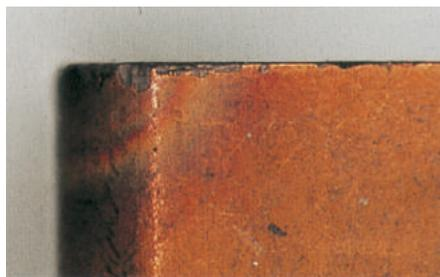
Выкрашивание - это незначительное повреждение кромки. Разница между выкрашиванием и сколами состоит в том, что при выкрашивании можно продолжать использование режущей пластины.
