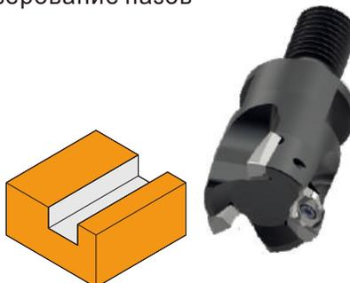
Многозубые фрезы, которые позволяют увеличить подачу, используются для ступенчатой обработки, а для обработки пазов используется инструмент с малым количеством зубьев, это позволяет уменьшить силы резания.
