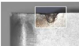
При точении проточки происходят на глубине резания. При нарезании канавок или точении износ канавок происходит во время подачи.
