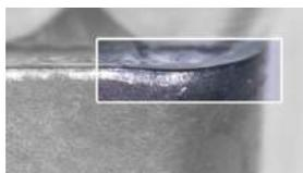
Боковой износ можно обнаружить при всех операциях обработки. Это нормальная часть износа.
