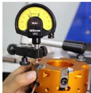
6. Используйте измерительный стол или приспособление для настройки инструмента, чтобы отрегулировать соответствующий размер всех картриджей инструмента до целевого размера. Допуск по высоте всех держателей инструментов находится в пределах  $\pm 2$  мкм.
