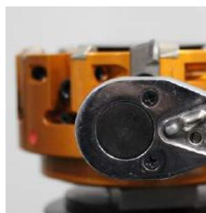
4. Установите картридж в гнездо корпуса и затяните его нижнюю часть регулировочным винтом. Предварительно затяните зажимной винт с усилием 4,5 Нм и регулировочный с усилием 1 Нм.
