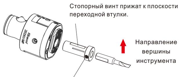
Стопорный винт втулки зажимает расточную оправку.
