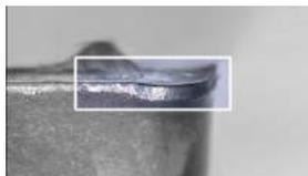
Пластическая деформация наиболее распространена при обработке канавок и точении. Причиной пластической деформации является слишком высокая температура на режущей кромке.
