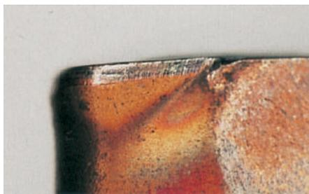
Пластическая деформация - необратимое изменение формы режущей кромки, где имело место либо вдавливание кромки, либо ее проседание.
