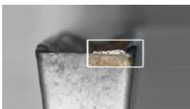
Наросты – наиболее распространенная форма износа при отрезке и обработке канавок. Обычно это происходит из-за слишком низкой температуры линии пластины.
