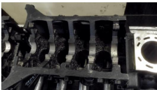
После обработки: Качество обработанной поверхности хорошее, плоскостность соответствует требованиям заказчика.
