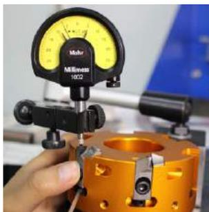
5. Отрегулируйте высоту всех картриджей до заданного значения с помощью осевых регулировочных винтов. Размер-0,01, затяните зажимной винт с усилием 14,5 Нм. Затяните боковые винты моментом 2,5 Нм.
