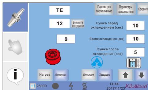
Термозажимная машина с водяным охлаждением
