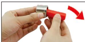
Снимите стопорное кольцо, как показано на рисунке. Инструмент наклонен, т.е. снят с гайки, снимите съемник. Установка завершена.
