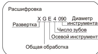
Примечание: Для обработки отверстий. Нельзя использовать для фрезерования!
