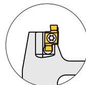
Индивидуальная расточная головка для обработки канавки торцевого уплотнительного кольца
