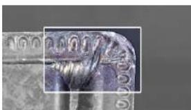
Лункообразование наиболее распространено при резке стали.
