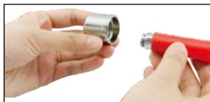
Установите стопорное кольцо в приспособление для снятия стопорных колец, а затем установите в гайку.
