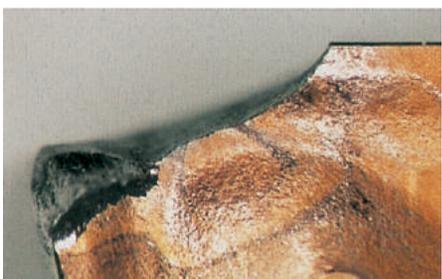
Сколы — это отламывание большого участка режущей кромки, при котором режущая пластина больше не может работать.
